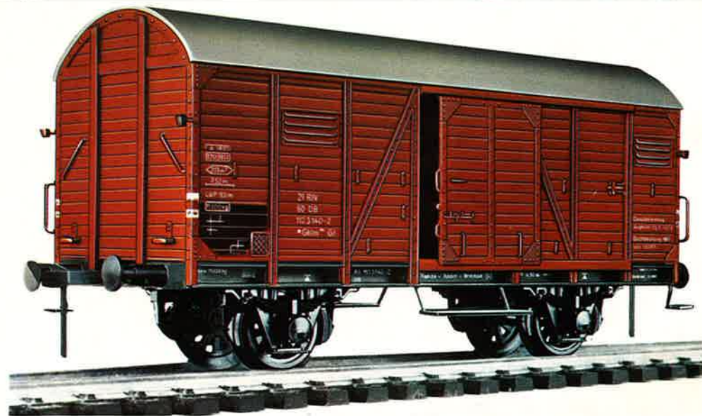
065 gedeckter Güterwagen der Type G 20, 2 Schiebetüren zum Öffnen und Schließen. Lüp 207 mm
